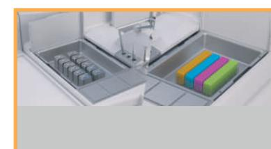
Съемные лотки для хранения кассет и форм. Излишки парафина сливаются в съемные ящики для отходов.
